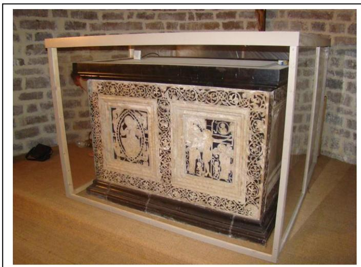
*Autel placé dans une enceinte provisoire permettant de stabiliser l'humidité et la température autour du marbre attaqué par les sels, dans l'église de l'ancienne abbaye de Gellone (Saint Guilhem le Désert, France).*
